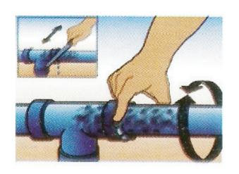
1° - Limpar bem a superfície e se possível lixar um pouco a superfície. Aplique a massa epóxi sobre o furo ou rachadura
